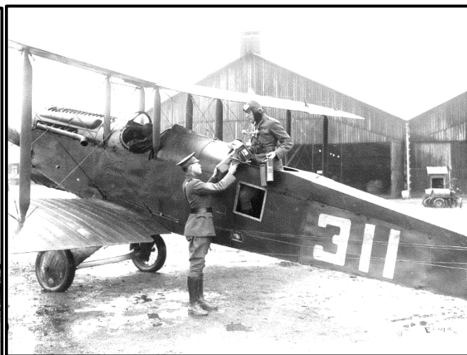
Figure 328. L'observateur avec l'appareil photo de vues aériennes, la fenêtre sur le flanc de l'avion permet à l'opérateur de disposer l'appareil photo. Noter, à l'arrière, le hangar de Parçay ; l'un dispose à son sommet d'une guérite permettant la surveillance de la piste (Source Archives US)
