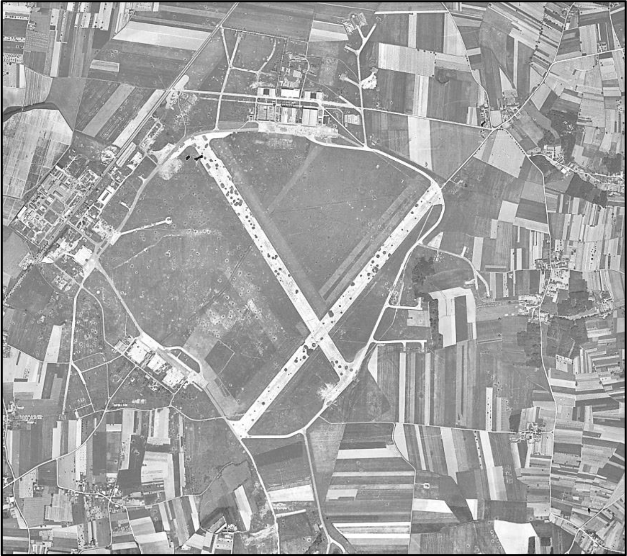
Figure 244. Vue aérienne d'après-guerre ; les installations allemandes sont visibles, dont les deux pistes en dur. Noter : les trous des bombardements anglo-américains de 1944 sont parfaitement visibles. (Source ; Géoportail)
