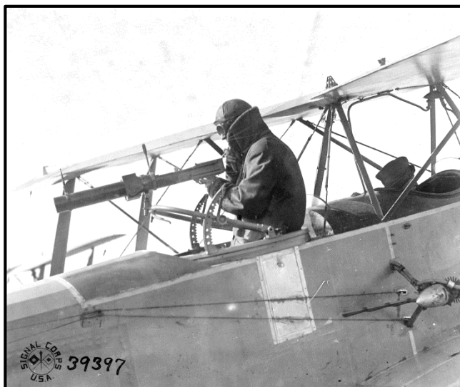
Figure 323. Pour simuler les combats aériens et valider les conditions de tir, la mitrailleuse a été modifiée en appareil photo. Sur la figure ci-dessus, on identifie la présence du boîtier photo par la partie parallélogramme en milieu du canon. Lorsqu'on appuie sur la gâchette un cliché est pris. (Photo Archives US)
