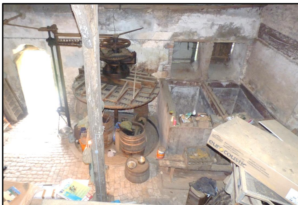
Figure 206. Le rez-de-chaussée fut transformé pour permettre l'exploitation des vendanges (cuves, pressoir, et fenêtres permettant de déverser les récoltes directement dans les cuves...) sur la gauche (non visible sur la photo on disposa un cellier pour la maturation du vin).
