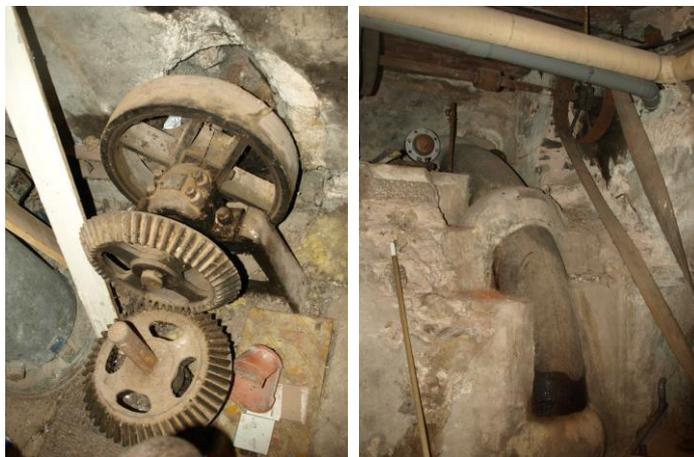
**Figure 62** Le bief par une conduite forcée, alimente en eau une turbine<sup>53</sup> qui entraîne une dynamo par des renvois de courroies et d'engrenages. Tout est encore visible (sauf l'alternateur) dans le sous-sol du Moulin.
